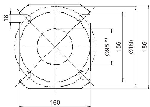
\*1 Минимальный диаметр для осуществления монтажа устройства очистки ленты и стандартного груза
